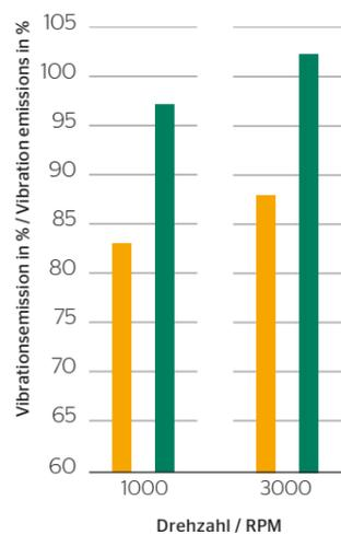
Ruhigere und präzisere Leistungsübertragung durch Schrägverzahnung. Vibrationen können im Vergleich zu herkömmlichen Zahnriemenantrieben um bis zu 20% reduziert werden.
