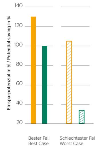
Der SILENTSYNC hat einen leistungsstarken Wirkungsgrad von 98% – beeindruckende 5% mehr als herkömmliche Keilriemenantriebe. Dadurch entstehen erhebliche Energieeinsparungen. Dieser Effekt ist vor allem bei Antrieben zu bemerken, die bis zu 24 Stunden pro Tag laufen.
