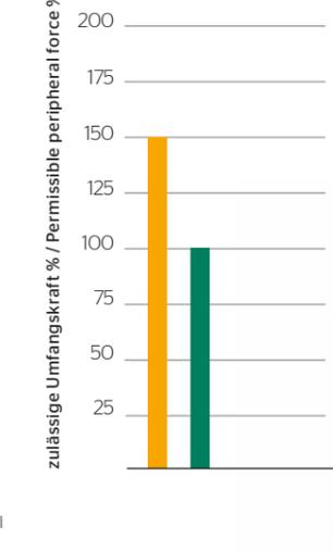
Die speziellen Materialien des SILENTSYNC erlauben es die Riemenbreite und das Gewicht zu reduzieren, ohne Kompromisse bei der Übertragungsleistung und der Laufzeit einzugehen. Durch die Selbstführung des Riemen werden keine Bordscheiben benötigt, was eine weitere Breiten- und Gewichtsreduzierung mit sich zieht.
